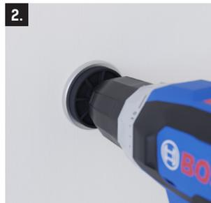
2. Rosette mit Adapter in die Bohrung für den Griff einsetzen und festdrehen.
